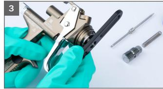
3 Al final, desatornillar la boquilla de pintura con la llave de anillo integrada en la herramienta universal.
