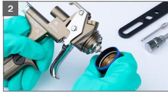
2 A continuación, desmontar la boquilla de aire.
